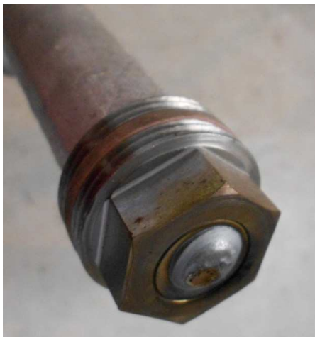
(A) Rechte anode, niet-geïsoleerd, niet-isoleerbaar
